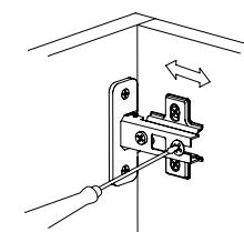
Регулировка вправо-влево. Регулируется юстировочный винт
