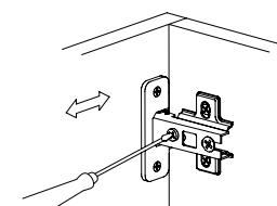
Регулировка вперед-назад. Регулируется крепежным винтом
