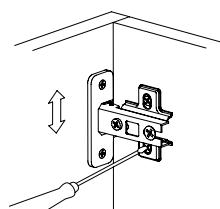
Регулировка вверх-вниз. Регулируются установочные винты
